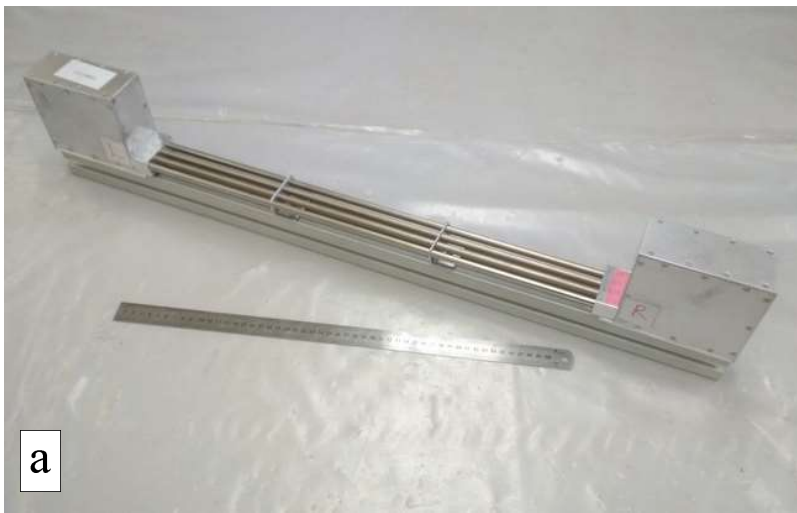
Рисунок 2.1.5.3. а) Модуль из 8 позиционно-чувствительных счетчиков; б) Модуль в стойке на 5 канале реактора ИР-8
