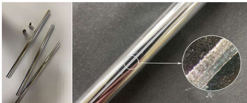
Рисунок 2.1.1.1. Сварной шов трубки из лавсана с покрытием B_4C на внутренней стороне цилиндра.
