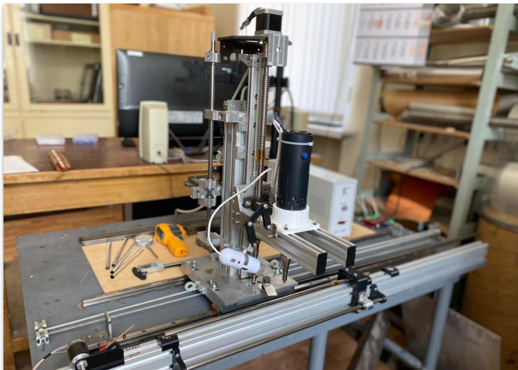
Рис. 3.1.10.4. Фотография станка для ультразвуковой сварки лавсановых straw-трубок диаметром 10 мм.
