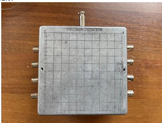
Рисунок 3.1.12.1. Прототип двумерного позиционно-чувствительного счетчика нейтронов.
