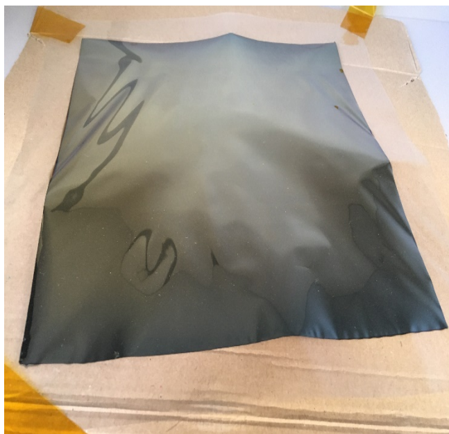
Рис. 1.1.3.2. Лавсановая плёнка с тонкоплёночным ^{10}\text{B}_4\text{C} .
