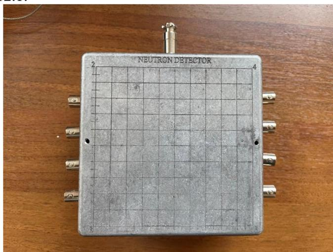
Рисунок 3.1.12.1. Прототип двумерного позиционно-чувствительного счетчика нейтронов.
