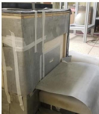
Рисунок 3.1.1.3. Блок с замедлителем и место расположения детектора.
