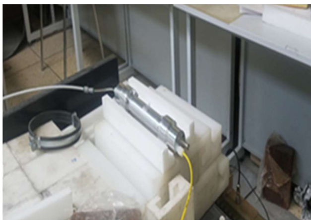
Рисунок 2.1.1.3. Установка прототипа детектора для тестов с источником нейтронов.
