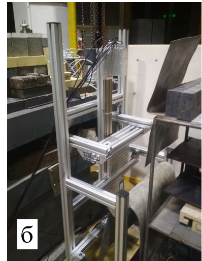
Рисунок 2.1.5.3. а) Модуль из 8 позиционно-чувствительных счетчиков; б) Модуль в стойке на 5 канале реактора ИР-8
