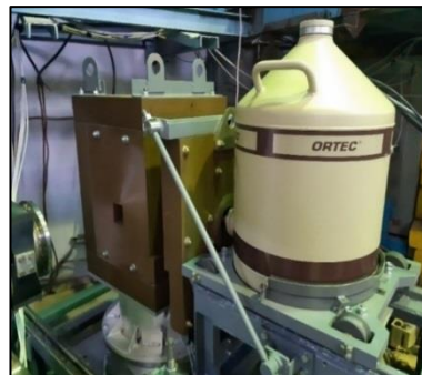
Канал регистрации гамма-квантов и позиция образца
