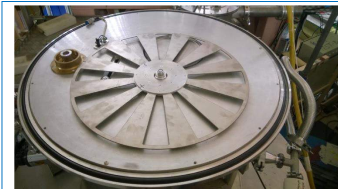
Рис. 53. Многощелевой Фурье прерыватель спектрометра Epigraph.
