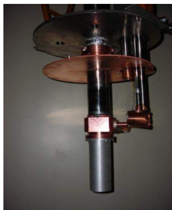
Рис. 71. Шахтный криостат для спектрометра НЕРА.
