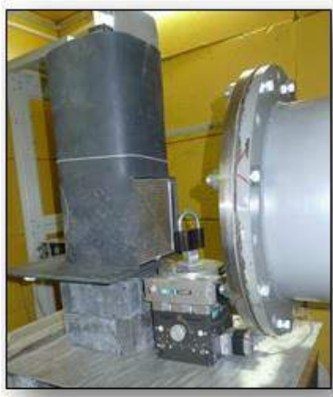
Рис. 18. Установка нейтронной радиографии и томографии на 14 канале ИБР-2.
