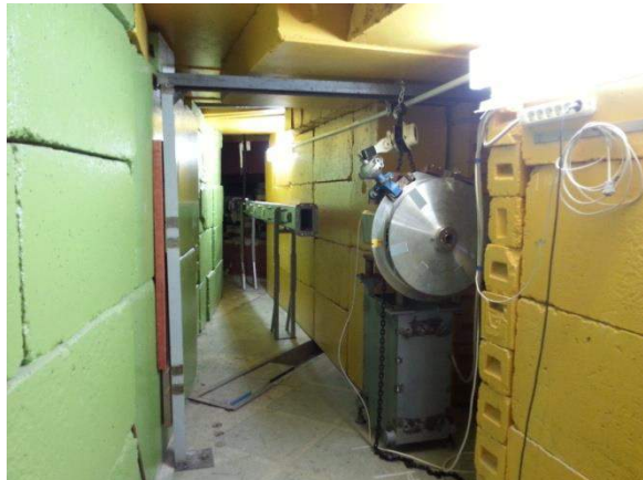
Рис. 63. Первая секция нейтронного волновода и Фурье-прерыватель на 13 канале ИБР-2
