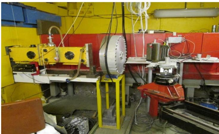
**Рис. 47.** Кольцевой гелиевый детектор обратного рассеяния на дифрактометре RTD
