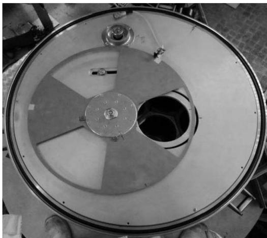
**Рис. 37.** Прерыватель-модулятор.
