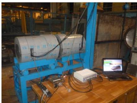
**Рис. 19.** 12-детекторная NaI(Tl) гамма-спектрометрическая система «Ромашка» (ИЯИЯЕ-БАН) на 4-ом канале импульсного нейтронного источника ИРЕН.
