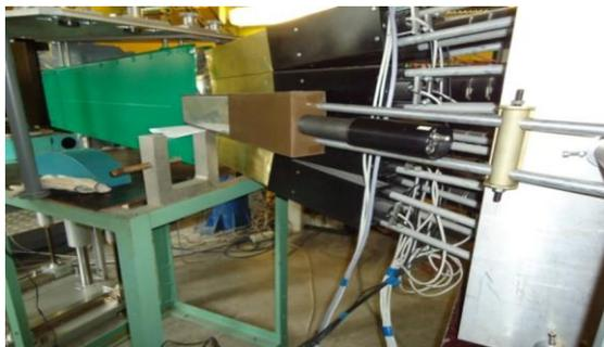
Рис. 53. Новый счетчик во время сравнительных испытаний на детекторе «Астра».
