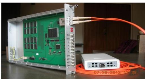
Рис. 56. Блок De-Li-DAQ2 для сбора и накопления данных с ПЧД.
