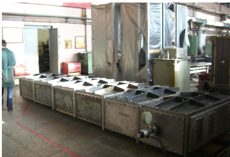
Рис.1. Кожух сплиттера на участке вакуумных испытаний.
