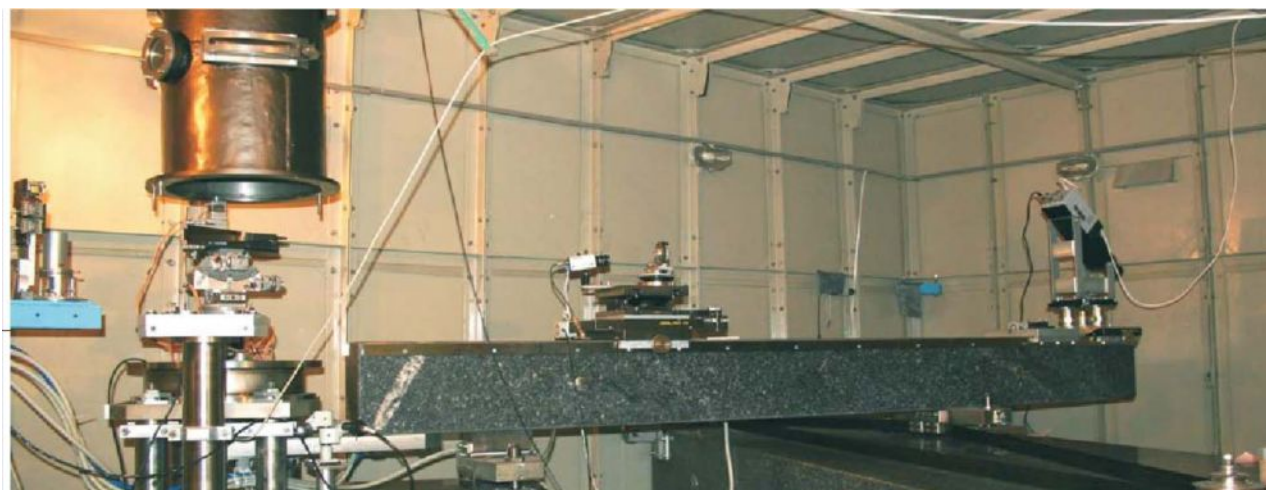
Рис. 16. Общий вид станции энергодисперсионной EXAFS-спектроскопии на источнике синхротронного излучения СИБИРЬ-2 в РНЦ КИ, изготовленной силами ОИЯИ.
