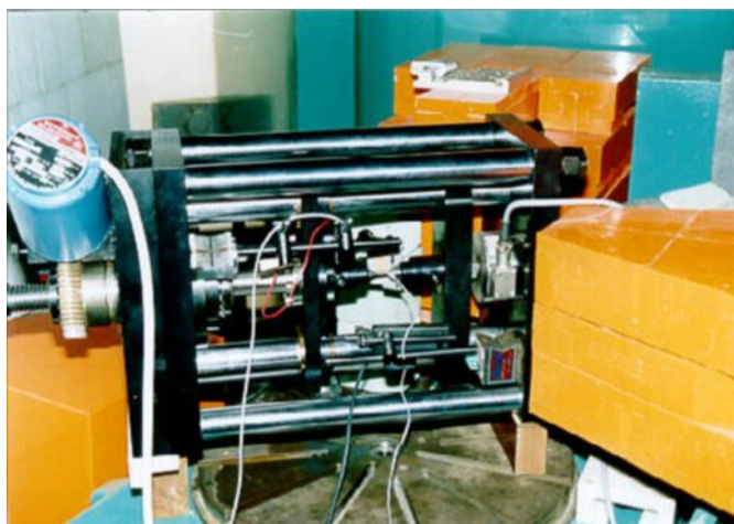
Рис. 15. Внешний вид нагрузочной машины для on-line экспериментов с металлами и сплавами. Машина позволяет реализацию различных статических и динамических (циклических) режимов работы.
