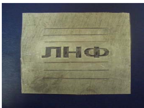
Рис.5. Измерение засветки с кадмиевой маской «ЛНФ» на 10 пучке ИБР-2. Газовая смесь 50мбар He^3 + 950мбар CF_4 . Время измерения 15 минут. Напряжение на аноде +3300В.
