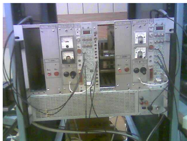
Рис.16. Прерыватель канала бб на базе электропривода постоянного тока (слева) и система управления (справа).
