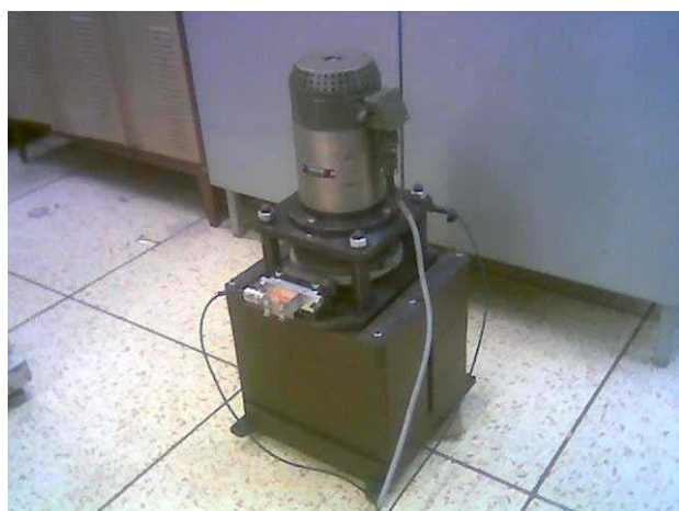
Рис.16. Прерыватель канала бб на базе электропривода постоянного тока (слева) и система управления (справа).
