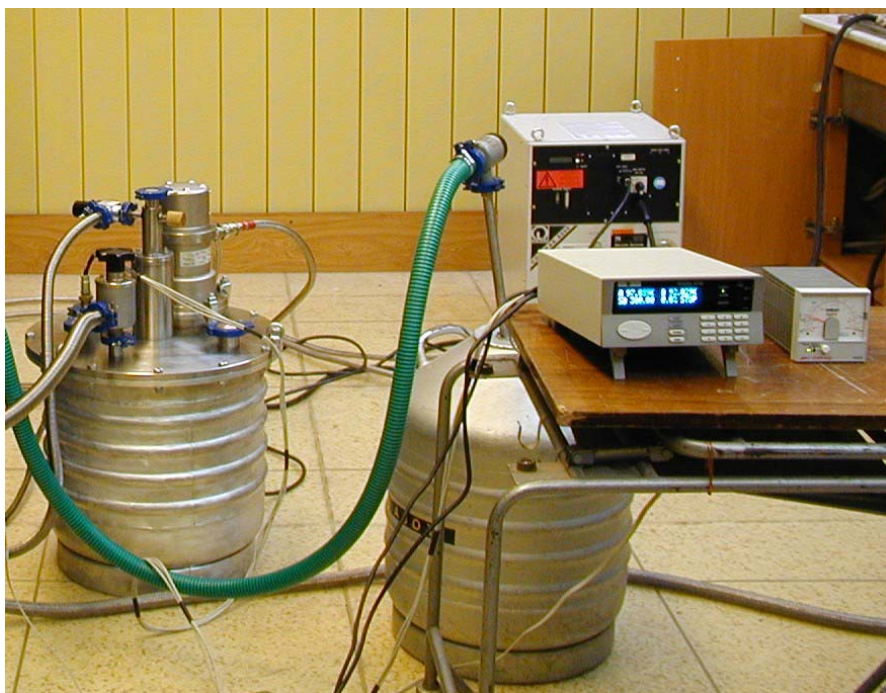
Рис.7. Шахтный криостат замкнутого цикла на базе двухступенчатого криогенератора CoolPower 100T
