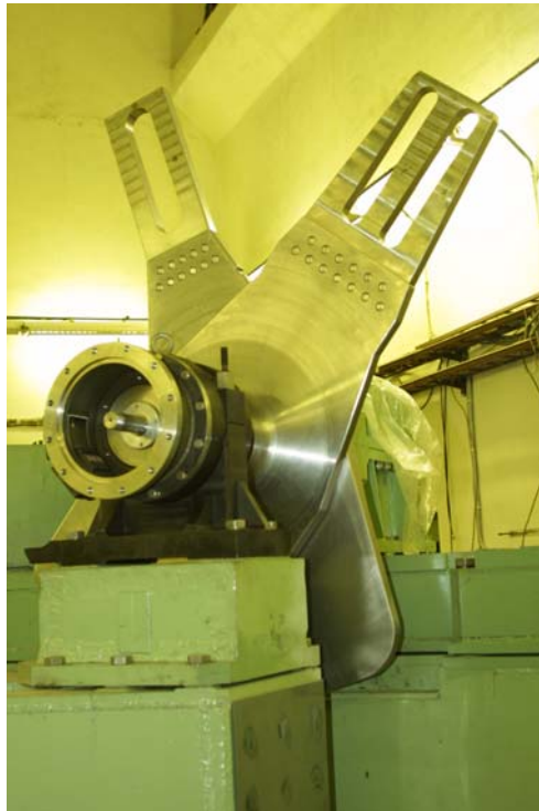
Рис. 1. Новый подвижный отражатель ПО-3 реактора ИБР-2 (основной и дополнительный модуляторы реактивности).
