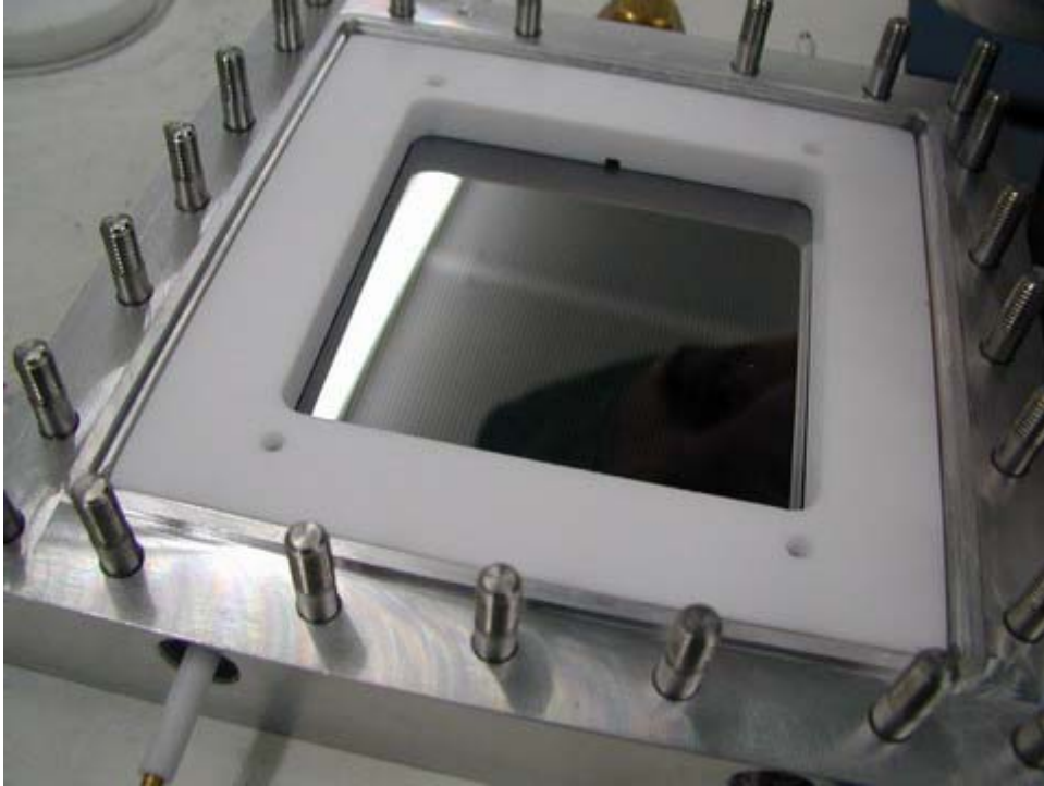
Рис. 2. MSGC детектор с виртуальным катодом
