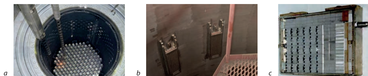
Рис. 1. а) Загрузка топлива на энергоблоке №3 Ростовской АЭС. Источник: https://sdelanounas.ru/blogs/55098/ . б) Образцы-свидетели, установленные в реактор пускового энергоблока №4 Ростовской АЭС. Источник: http://www.atominform.ru/news/w0801.htm . в) Открытый контейнер с образцами-свидетелями для реактора ВВЭР-1000 (АЭС Темелин, Чехия). Источник: https://repository.lib.ncsu.edu/bitstream/handle/1840.20/27086/D02-5.pdf?sequence=1&isAllowed=y
