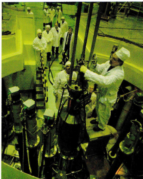
Загрузка активной зоны реактора ИБР-2М
