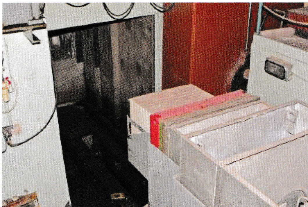
Экспериментальная ниша с откатным коробом и защитной откатной дверью
