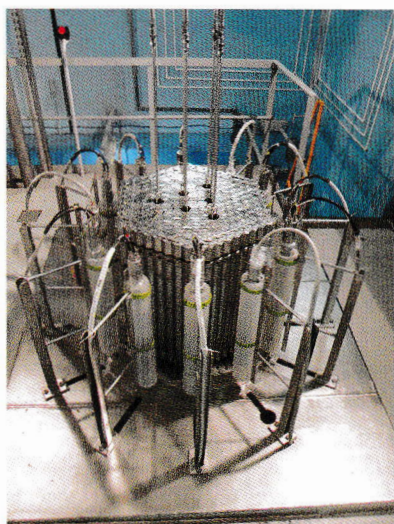
Критическая сборка с гидридциркониевым замедлителем
