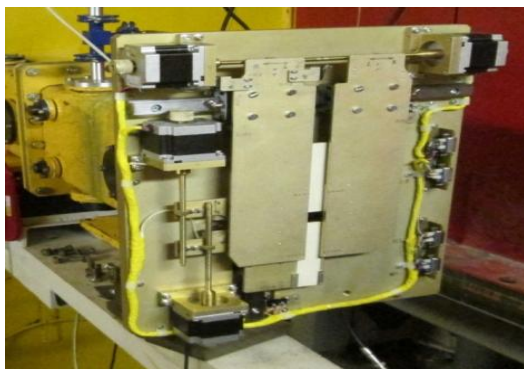
Рис.38. Регулируемая диафрагма нейтронного пучка дифрактометра RTD
