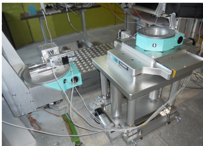
Рис.37. Гониометр и сканер Huber на дифрактометре ФСД
