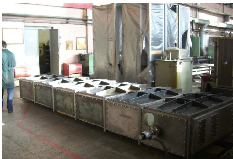
Рис.1. Кожух сплиттера на участке вакуумных испытаний.
