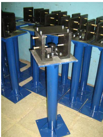
Рис.2. Юстировочные опоры изогнутых нейтронных систем
