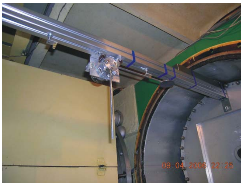
Рис.5. Устройство ввода рассеивателя в нейтронный пучок.
