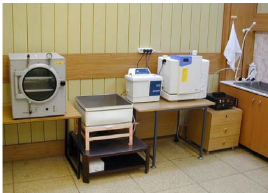
Рис.1. Вакуумная печь, система очистки воды и ультразвуковая печь
