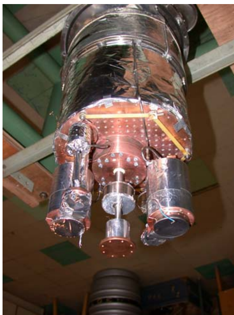
Рис.9. Микрорефрижератор с сорбционной откачкой для получения температур до 0.3 К.
