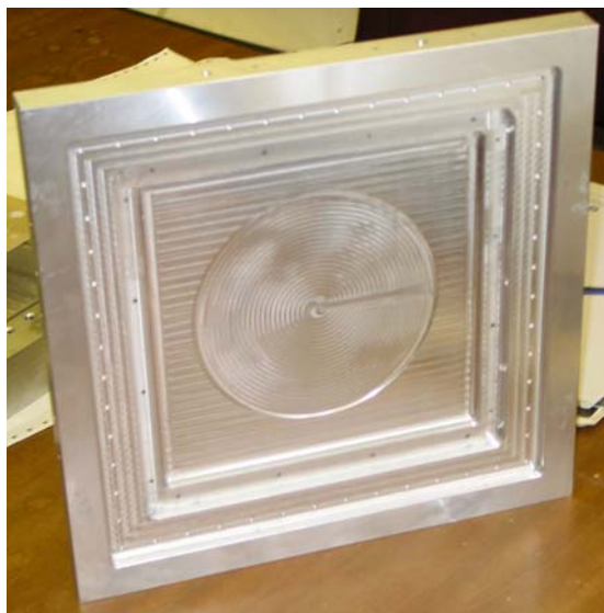
Рис.5. Корпус мониторного детектора (слева) и рамки электродов (справа)
