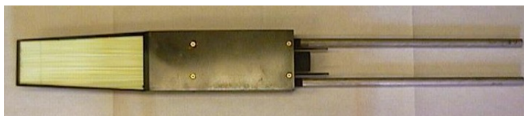
Рис.6. Модуль 90^{\circ} сцинтилляционного детектора с временной фокусировкой ASTRA.
