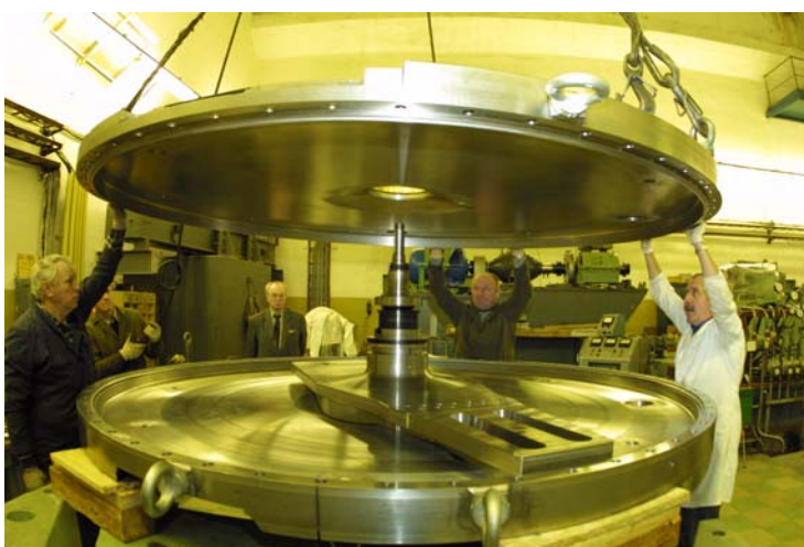
Рис. 1. Новый подвижный отражатель ПО-3 реактора ИБР-2 (основной и дополнительный модуляторы реактивности).
