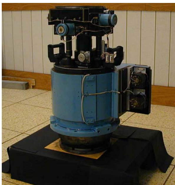
Рис.6. Система управления положением образца на базе сканера и платформы с поворотным «плечом» для размещения детектора на спектрометре ДСД
