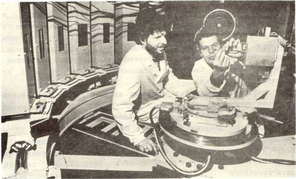
Текстурный нейтронный дифрактометр НСВР на пучке № 7а реактора ИБР-2
