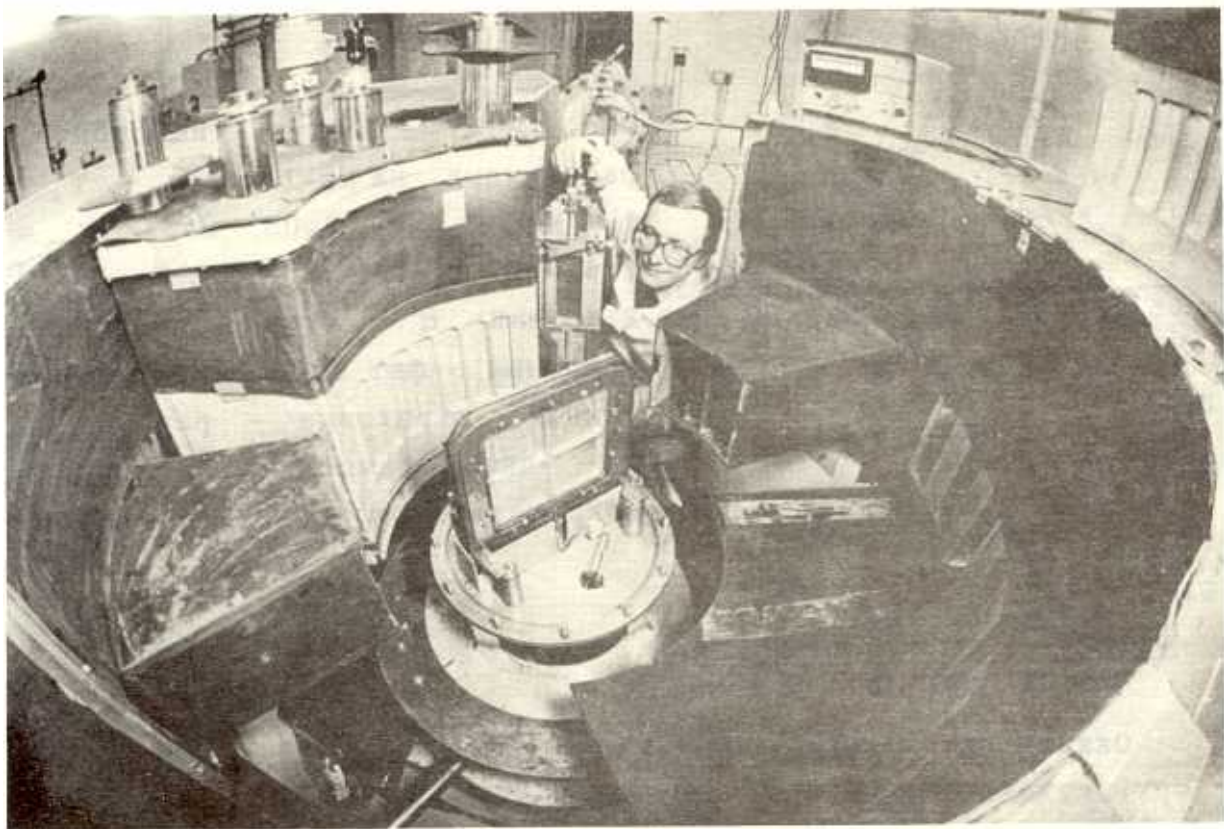
Спектрометр неупругого рассеяния нейтронов в обратной геометрии НБРА-ПР на пучке № 7б реактора ИБР-2
